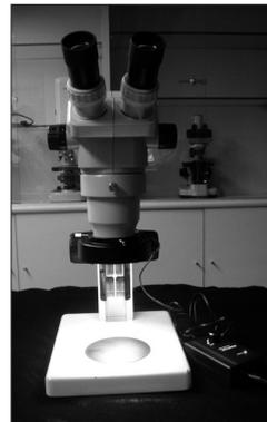
*Photo 2.* – Anneau de diodes en place sur une loupe binoculaire (documentation du vendeur).
